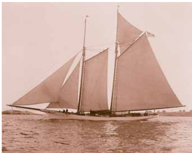
Nella foto si notano i cambiamenti voluti dal generale Butler nel 1855; bompreso più lungo e inclinato verso l'alto, alberi meno inclinati verso poppa e allungamento del trinchetto (Library of Congress, Detroit)
